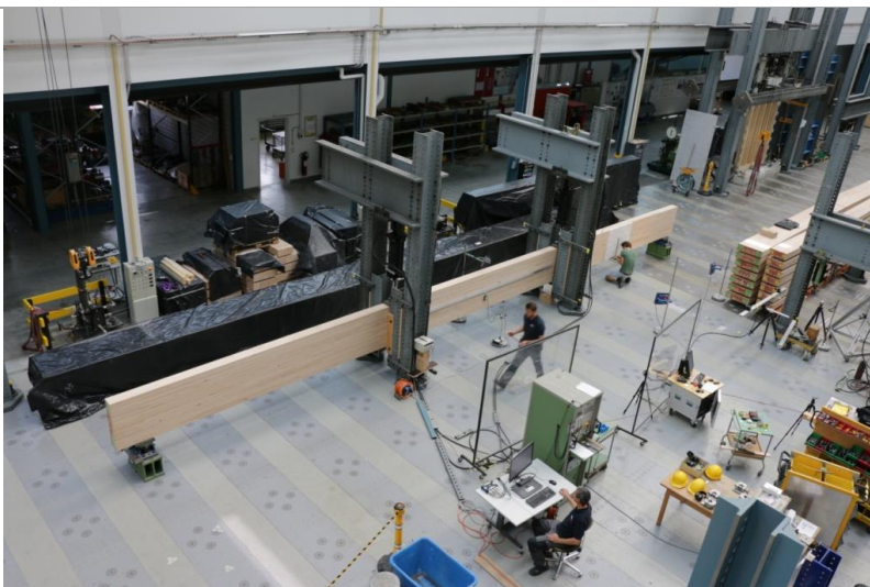
Bild 3 Vorbereitungen für die 4-Punkt Biegeprüfung eines 800 mm hohen und 15.20 m langen Trägers der Festigkeitsklasse GL48c. (Bildnachweis Robert Widmann, Empa Dübendorf)
