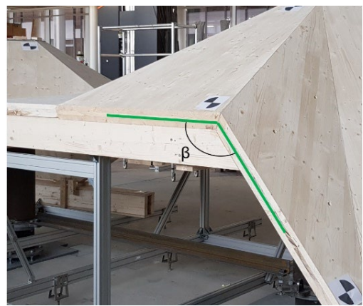
Abb. Faserwinkel in der Ebene \alpha und aus der Ebene \beta beim Plattenstoss
