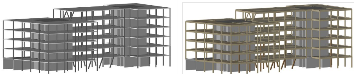
Abb. 4: Links: Betonvariante mit punktgestützten Flachdecken. Rechts: Ausgeführter Holz-Beton-Hybridbau
