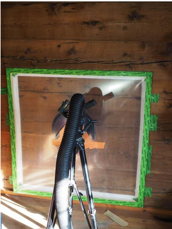
Abb. 2: An der Aussenwand montierter Messrahmen des MLM-Messgerätes
