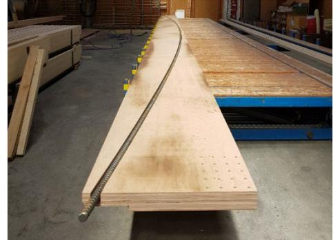
Abb. 3: Links: Visualisierung Plattform, Rechts: Zwillingsträger mit eingelegter Vorspannstange
