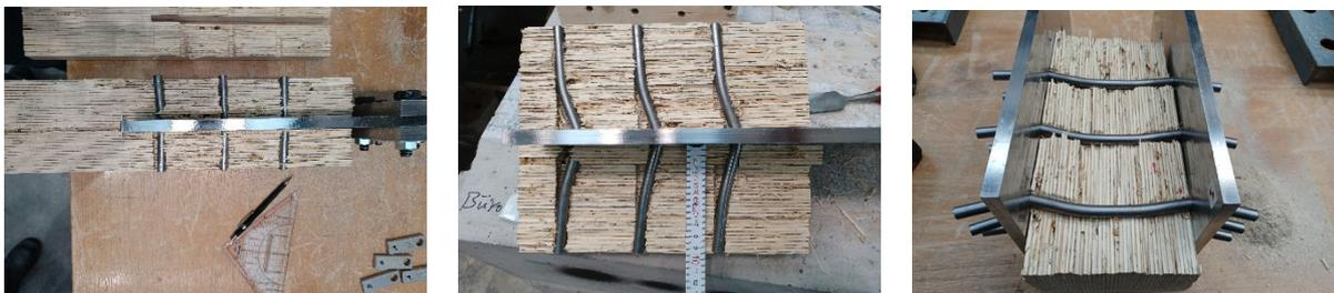
Abbildung 11: Verformungen der Stabdübel mit Versagensmodus II (links), Versagensmodus III (mitte) und Verbindung mit zwei Stahlblechen IV (rechts)
