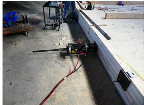
Abb. 4: Links: Visualisierung Plattform, Rechts: Vorspannung der Platte
