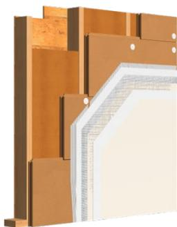
Abb. 30 Klassischer Aufbau eines Holzfaser-WDVS im Holzbau
