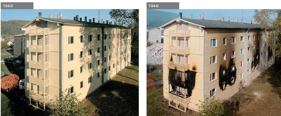
Abb. 5 Naturbrandversuche an einem Gebäude
