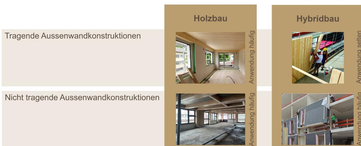
Abb. 19 Einordnung Aussenwandkonstruktionen nach Bausystemen
