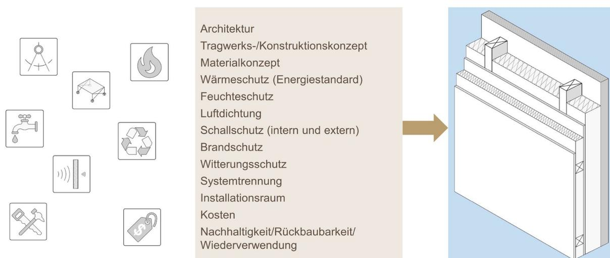
Abb. 18 Anforderungen an Aussenwandkonstruktionen ([1] modifiziert)
