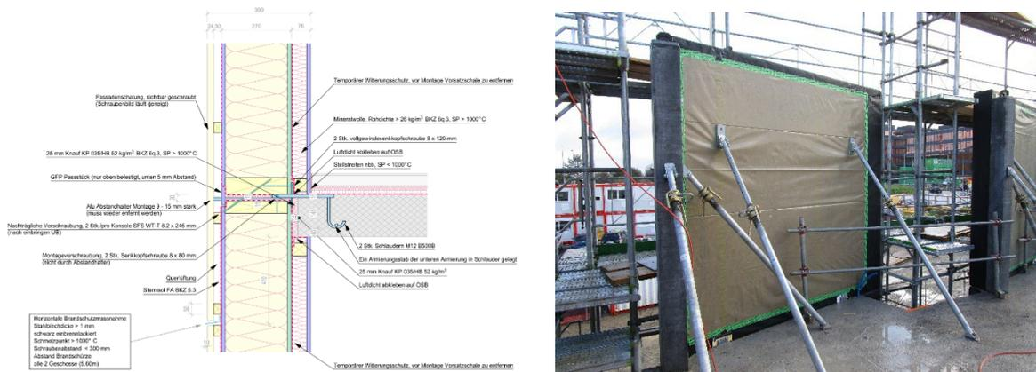
Abb. 20 Vorgängig montierte, nicht tragende Aussenwandkonstruktion (anspruchsvolle Fassadengeometrie)
