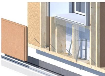
Abb. 36 Vorgeständerte Holzkonstruktion für WDVS
